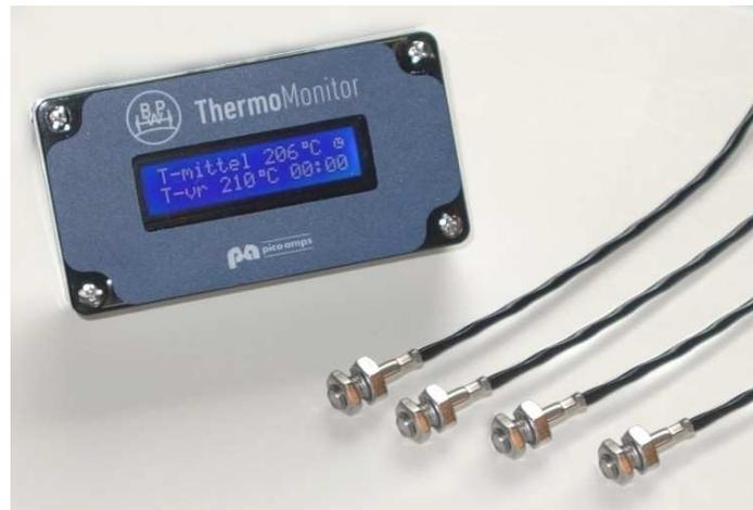
Das ThermoMonitor Mess-System ist eine kostengünstige Lösung für die vom BMVI geforderten Temperaturüberwachung an thermoisolierten Transportmulden. Das System eignet sich zur **Neuausrüstung und Nachrüstung** von Fahrzeugen.
